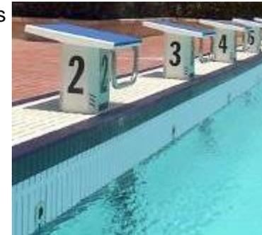
Construcción. La estructura es de acero inox, y está construida en secciones que son en general de la misma anchura que las calles. Cada sección se soporta tanto en la parte delantera como en la posterior: las patas anteriores van enroscadas en un plato de anclaje insertado en el borde rebosadero, mientras las patas posteriores se apoyan directamente sobre el pavimento.
