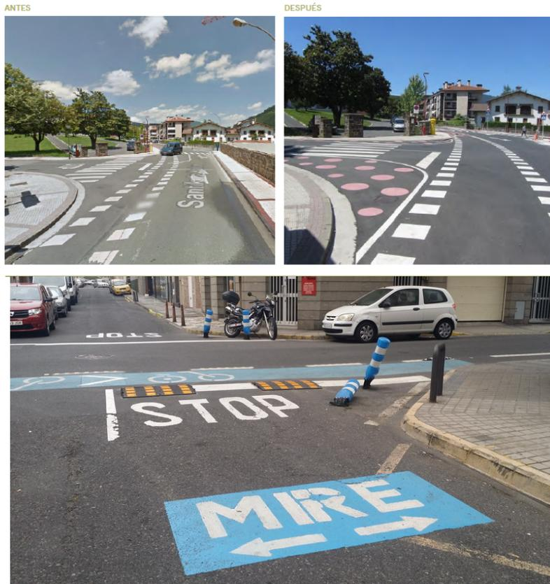
Elementos de señalización y balizamiento protegiendo una vía ciclista dispuesta a contramano.
